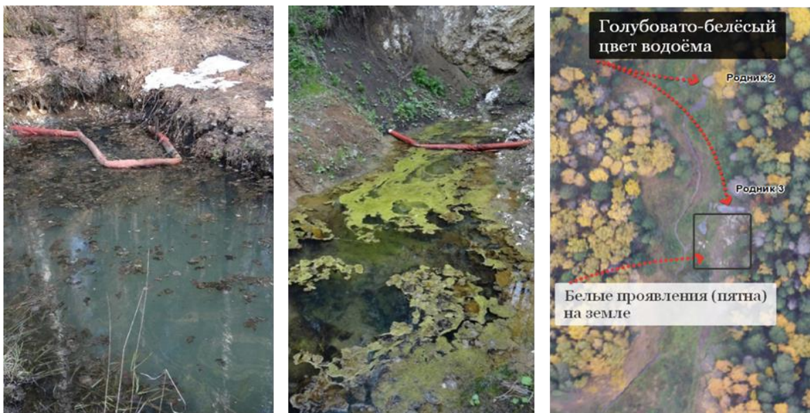
Рис. 7. Признаки галогенеза: смена цвета водоёмов на голубовато-белёсый с помутнением (Родник 2 – ПП2 (27.04.2017 г.)), зелёно-жёлтый (Родник 3 – ПП3 (02.06.2017 г.)), пятна солепроявлений на поверхности земли (южнее ПП3). Аэрофотосъемка проведена 29.09.2016 г.
