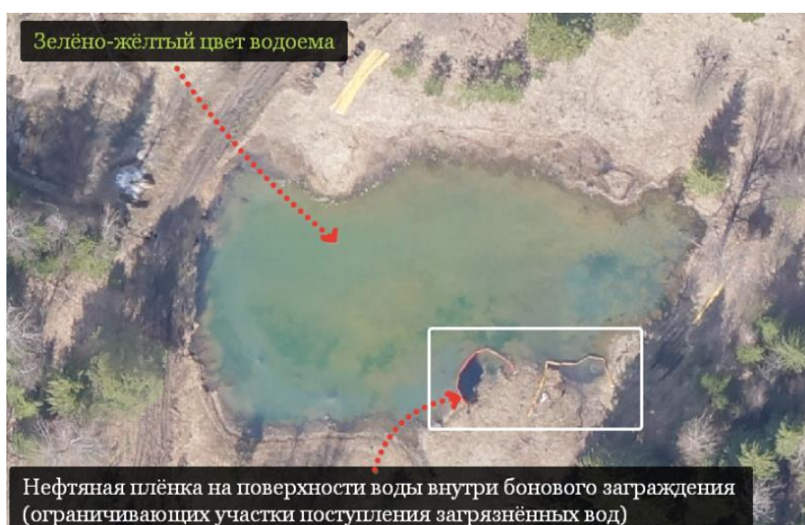
Рис. 4. Признаки битумизации и галогенеза пруда-нефтеловушки (ПП 18) Аэрофотосъемка проведена 29.04.2016 г.
