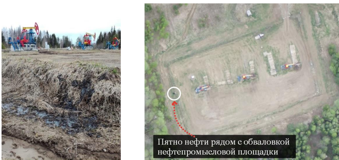
Рис. 5. Нефтяное проявление на границе куста скважин № 9 (Фото 10.05.2018 г.). Аэрофотосъемка проведена 25.05.2018 г.
