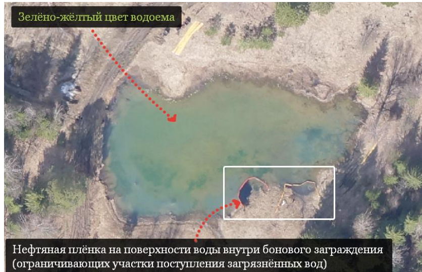
Рисунок 26. ПП 18. Признаки битумизации и галогенеза пруда-нефтеловушки (Фото 28.04.2017 г.). Аэрофотосъемка проведена 29.04.2016 г.
