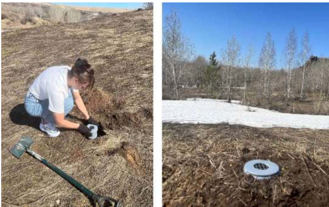
Рисунок 8 – Установка пылеуловителя Таубера на точке отбора
